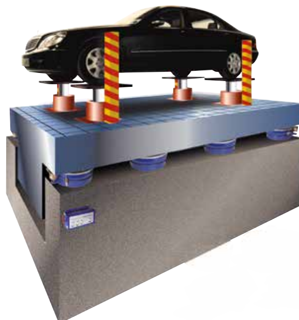
Prüfstände, Beispiel Straßensimulationsprüfstand
